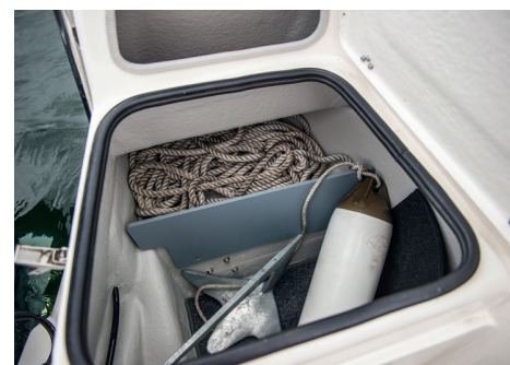
▲ En rejält tilltagen ankarbox med separat fack för linan är en av TG:s många genomtänkta detaljer.
